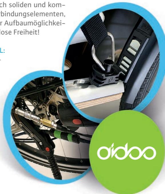
Ein Fahrradanhänger war bisher überwiegend eine simple und sperrige Konstruktion und somit mehr eine Krücke denn ein echter Helfer. Das ausgeklügelte *aidoo* Konzept zeigt auf, was ein Trailer heute wirklich leisten kann. Das Rückgrat bildet ein spezielles Alu-Profil mit einem Edelstahlrohr, auf welches sich mit besonderen Spannklammern in Sekunden beliebige Aufbauten montieren lassen.
